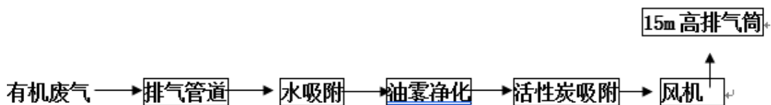
图 4-1 有机废气治理流程图
