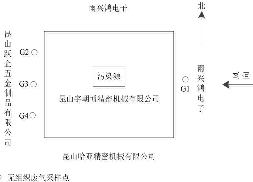
图 7.1-1 本项目废气监测点位示意图
