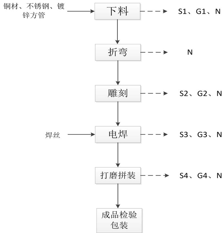
图 3.5-1 生产工艺流程图
