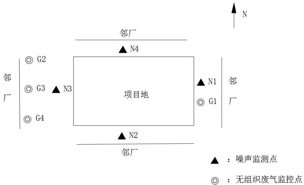
图 7.1-1 本项目废气、噪声监测点位示意图
