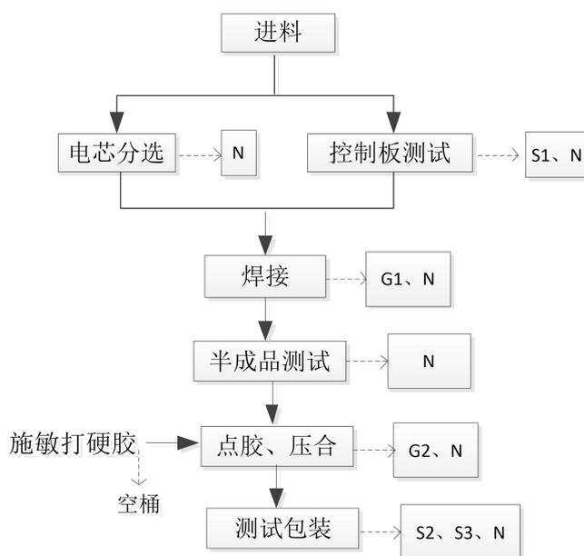
图 3.5-1 生产工艺及产污环节图
