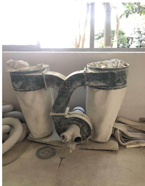
移动式布袋除尘装置（切割工段）
