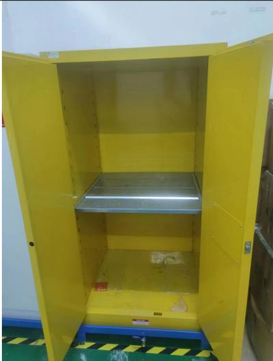
防爆柜内置物板凹槽、底部槽体
