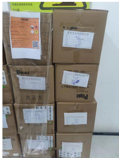
固态危废暂存于栈板、密闭保存
