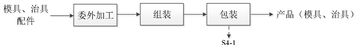
图 2-6 模具、治具生产工艺流程图
